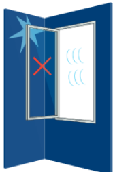
Skrzydła uderzające w sposób niekontrolowany (np. gdy wieje silny wiatr) o wnękę okienną mogą spowodować uszkodzenia ościeżnicy, okuć lub wnęki. Zalecenie: używanie ogranicznika otwarcia (reguluje kąt otwarcia) lub stopera drzwiowego.
